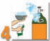
Apretar de más la conexión puede deformar o dañar la junta. Verifique fugas sólo con agua de jabón.
